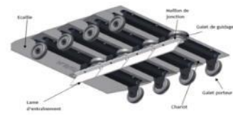
Carrousels : vibrations châssis - galet - moteur
