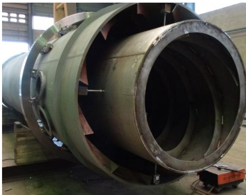
Figure 39 : Photo d'un sécheur à tambour rotatif (source : Lessine)
