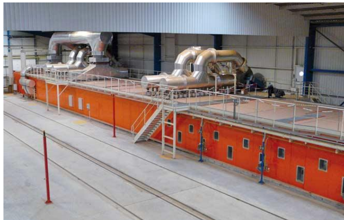
Figure 33 : Illustration d'un four tunnel matériaux (source : ICV)
